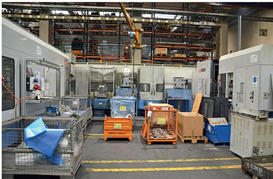
3 Gebraucht gekauft und von Mazak in Betrieb genommen: Beinbauer betreibt auch zwei Palletech-Anlagen mit je einem Horizontal-BAZ, 32 Palettenplätzen im Hochregal-Bahnhof sowie je einem Rüstplatz; sie sorgen mittlerweile für effizientere Abläufe bei Bauteilen mit mehreren Spannlagern (© Hanser)
