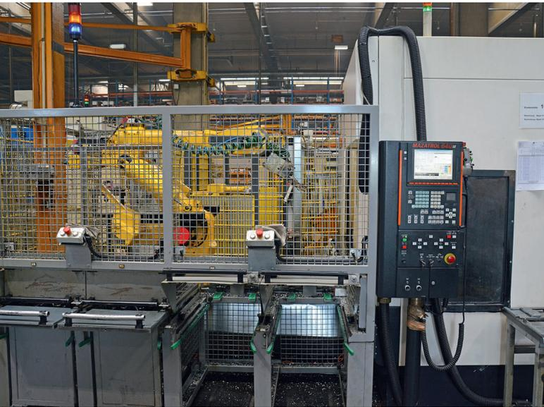
4 Automation und Mehrmaschinenbedienung weit verbreitet: Mazak-Maschinen, wie diese VTC-200 C II, werden bei Beinbauer Automotive ab mittleren Losgrößen auch von Robotern be- und entladen (© Hanser)
